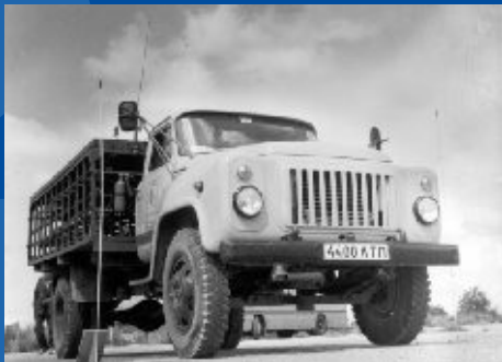
Sašķidrinātās naftasgāzes balonu pārvadāšanas automašīna.
